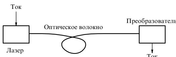
Рис. 1. Схема линии передачи энергии.
