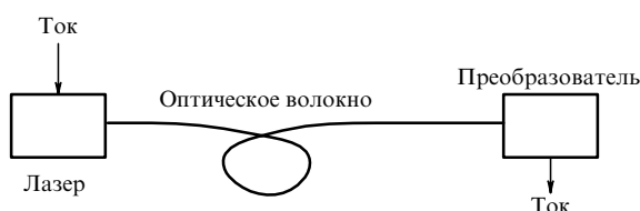
Рис. 1. Схема линии передачи энергии.
