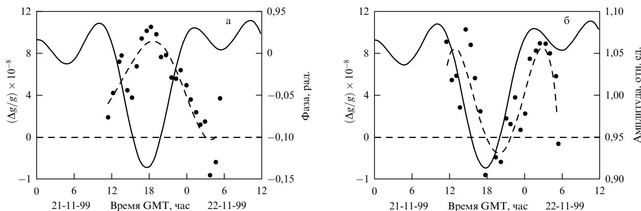
**Рис. 6.** Временные зависимости амплитуды (а) и фазы (б) сейсмоакустической волны, распространяющейся в массиве нефтегазонасыщенного песчаника (частота 167 Гц, дистанция распространения 360 м). Штриховые кривые — аппроксимация экспериментальных точек; сплошные — изменения относительного ускорения силы тяжести, вызванного лунно-солнечным приливом [23].
