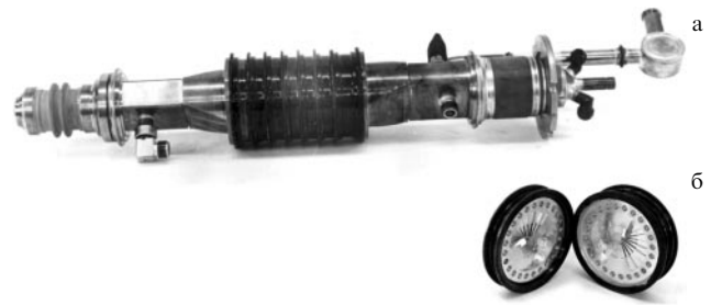
Рис. 17. Общий вид экспериментального макета ЛБЦПВ (а) и фрагменты замедляющей системы в виде пространственно скрученной двухрядной гребенки (б).
