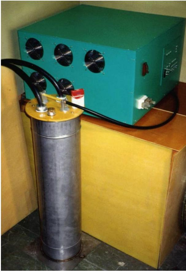
**Рис. 6.** Генератор мощных наносекундных импульсов. Импульсное напряжение 70 кВ, ток в импульсе 3 кА, скорость нарастания 3–5 нс, энергия в импульсе 2 Дж, частота повторения до 2 кГц.
