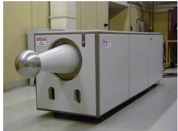
**Рис. 9.** Генератор S-5N. Выходное напряжение 400–1000 кВ, ток в нагрузке 1–3 кА, длительность импульса (FWHM) 30–50 нс. Частота следования импульсов: постоянно — 300 Гц, пачка (30 с) — 900 Гц. Входная средняя мощность: постоянно — 18 кВт, пачка (30 с) — 45 кВт. Габариты корпуса 3,5 × 1,4 × 1,1 м, масса  $\sim 2800$  кг.
