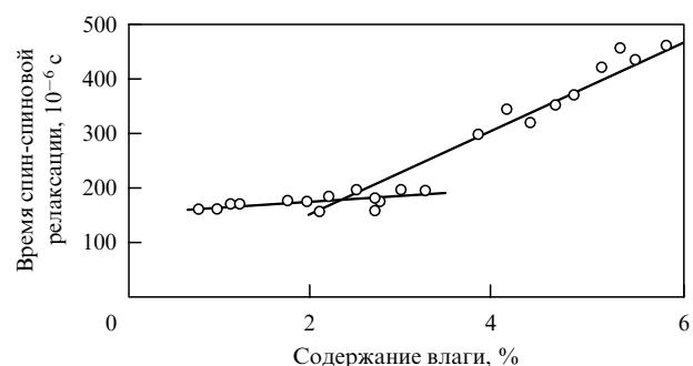
Рис. 10. Зависимость времени спин-спиновой релаксации от процентного содержания влаги в угле марки Т [70].
