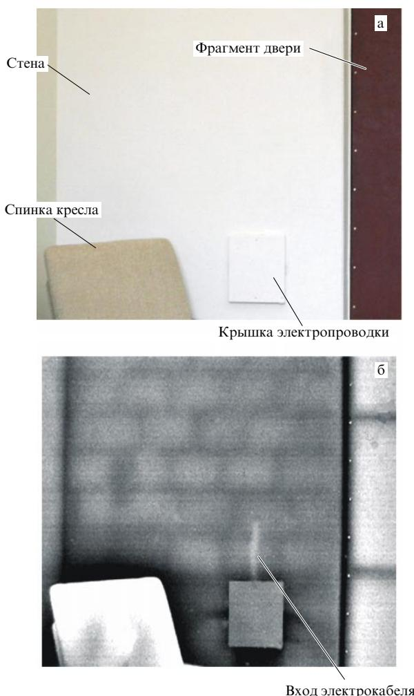
Рис. 1. Обнаружение кладки стены через слой штукатурки: (а) изображение стены в видимом свете, (б) изображение стены в тепловизоре.
