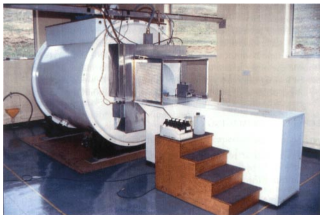
Рис. 1. Сконструированный в нашей лаборатории магнитно-резонансный томограф на основе сверхпроводящего магнита с полем 0,5 Тл.
