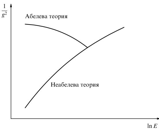
**Рис. 2.** Зависимости эффективных констант связи от энергии в абелевых и неабелевых калибровочных теориях. Верхняя кривая отвечает нуль-заряду, нижняя — асимптотической свободе.
