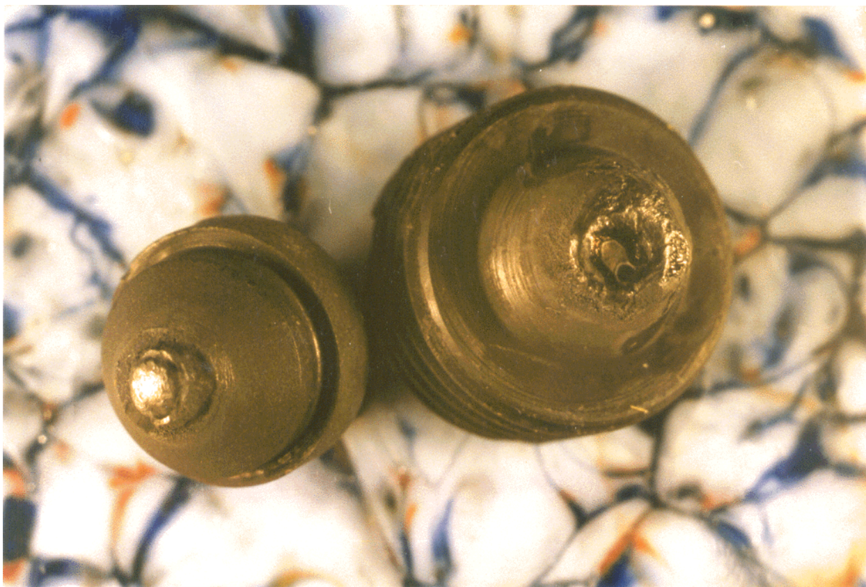
Рис. 20. Плавкий предохранитель после нагрева.
