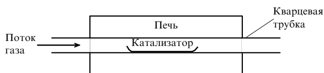
Рис. 11. Схема установки для получения УНТ методом химического осаждения [70–74].
