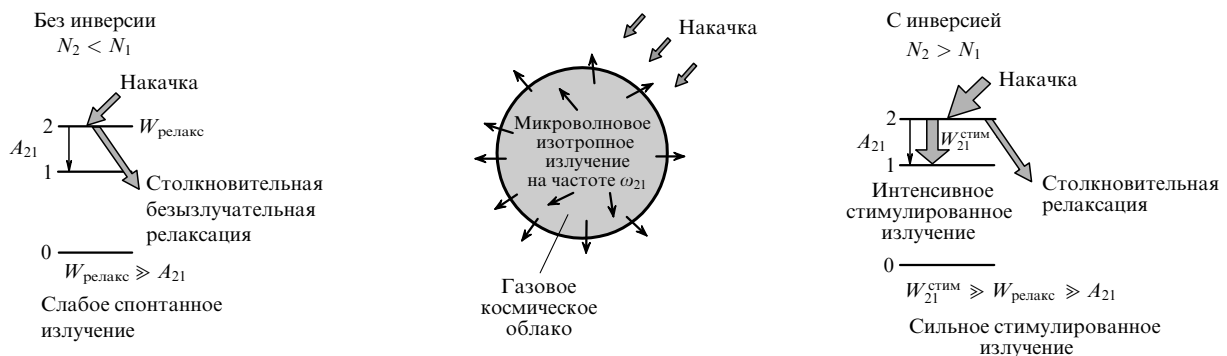
Рис. 1. Переход от режима слабого изотропного спонтанного излучения в среде без инверсии (слева) к режиму сильного изотропного стимулированного излучения в среде с инверсией (справа) в микроволновом случае.
