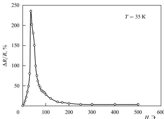
Рис. 6. Зависимость магнетосопротивления  $\Delta R/R$  полуметаллического сплава Гейслера NiMnSb от напряженности магнитного поля при температуре 35 К.
