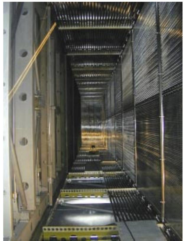
Рис. 20. Внутри субмодуля ICARUS массой 300 т; вид одного из двух зеркальных дрейфовых объемов. О том, что это проволочная камера, можно догадаться по наклонному треку слева, образованному бликами света на проволоках.
