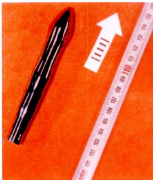
Рис. 2. Монокристалл изотопически чистого 70 Ge с обогащением 99,99 %.
