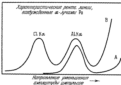
Рис. 24. Кривые распределения амплитуды от алюминиевого диска, покрытого полонием (кривая A) и после покрытия пленкой из пластмассы «Saran» (кривая B).
