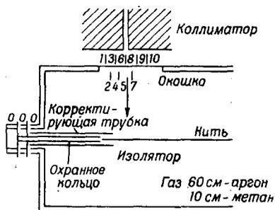
Устройство счётчика с коррекционной трубкой.
