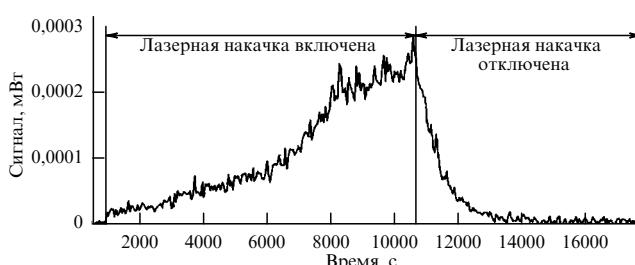
**Рис. 10.** Процесс загрузки атомов Rb в поверхностный потенциал в зависимости от времени  $t$  воздействия на атомы лазерного излучения [39].
