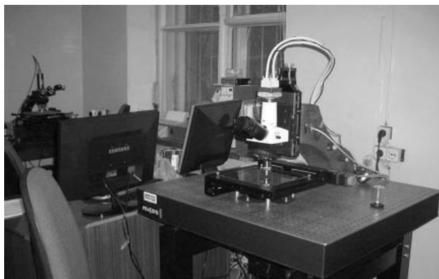
Рис. 1. Автоматизированный микроскоп ПАВИКОМ-3: оптическая система "Nikon"; прецизионный стол "miCos" (перемещение по осям: X = 120 \text{ мм} , Y = 120 \text{ мм} , Z = 30 \text{ мм} ; точность измерения координат 0,5 \text{ мкм} ); CMOS-видеокамера "Mikrotron MC-1310" (глубина цвета до 10 бит; размер изображения 1280 \times 1024 пикселей, скорость — до 500 кадров в секунду) (CMOS — от англ. Complementary-symmetry/Metal-Oxide-Semiconductor — комплементарная логика на транзисторах металл–оксид–полупроводник); рабочая станция, плата оцифровки и обработки изображений "Matrox Odyssey XPro".
