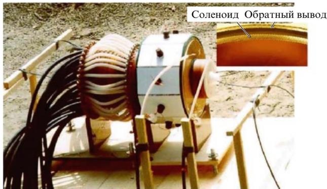
Рис. 1. Внешний вид подготовленного к взрывному эксперименту каскадного генератора МК-1. На вставке приведён фрагмент поперечного сечения соленоид-оболочки генератора МК-1.
