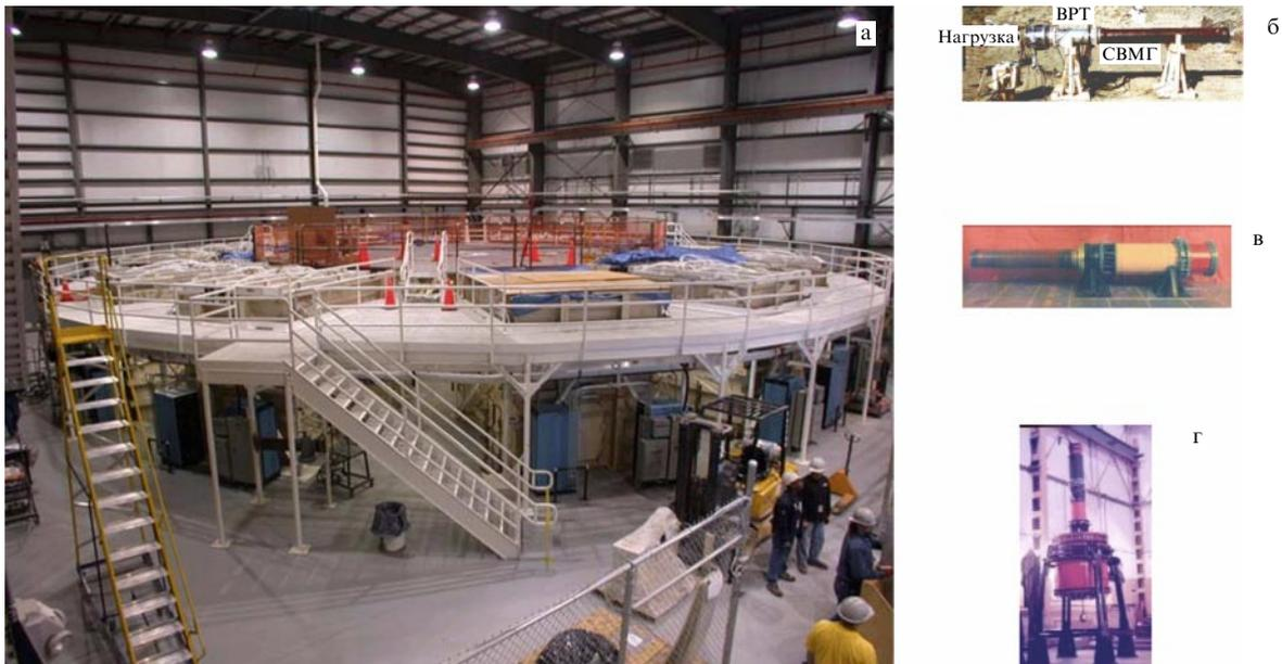
**Рис. 5.** (а) Установка "Atlas" (Невада, США), создающая ток амплитудой до 30 МА за время  $\approx 5$  мкс; скорострельность — один эксперимент в две недели (стоимость капитальных затрат 43 млн долларов США). (б) СВМГ с ВРТ: ток 20 МА за 1–2 мкс (стоимость изготовления около 150 тыс. долларов США). (в) ДВМГ семейства "Поток": диаметр 400 мм, ток 100 МА за 6 мкс (стоимость изготовления около 250 тыс. долларов США). (г) ДВМГ семейства "Поток": диаметр 1000 мм, ток 300 МА за 10 мкс.
