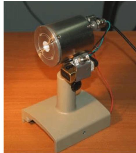
**Рис. 5.** Пироэлектрический измеритель энергии ТГц-импульсов.
