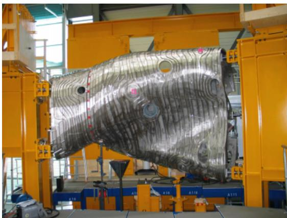
Рис. 9. Фрагмент вакуумной камеры W-7X (половина модуля).
