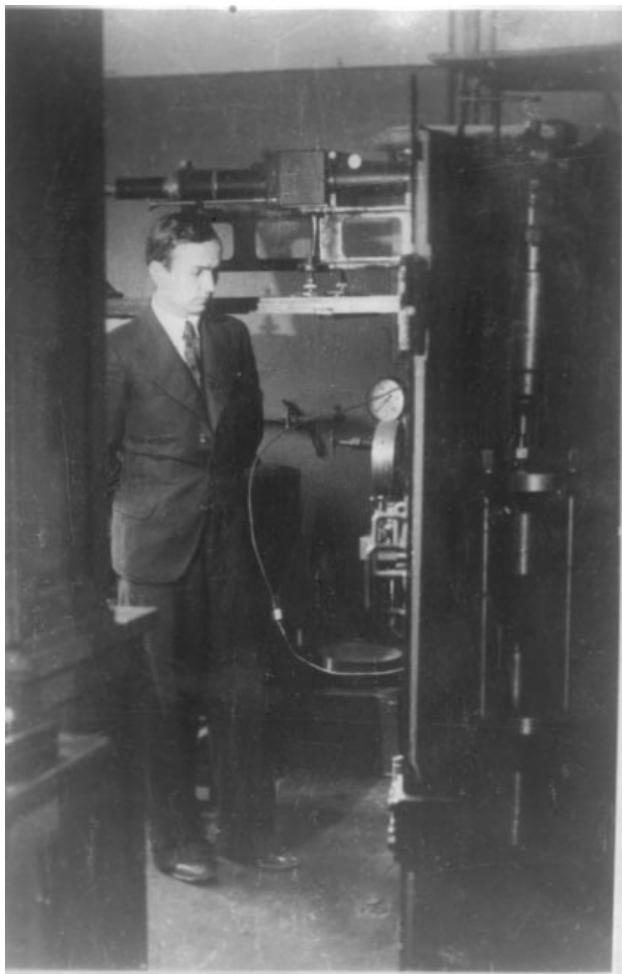
Рис. 1. Л.Ф. Верещагин у разработанного им гидрокомпрессора.
