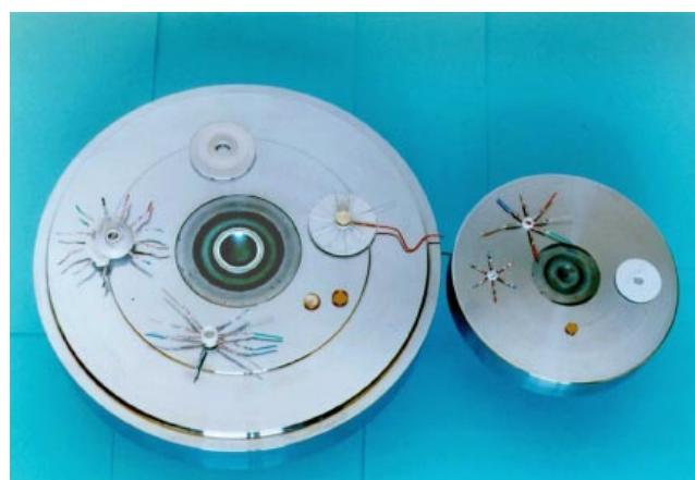
Рис. 8. Камеры высокого давления типа "тороид".
