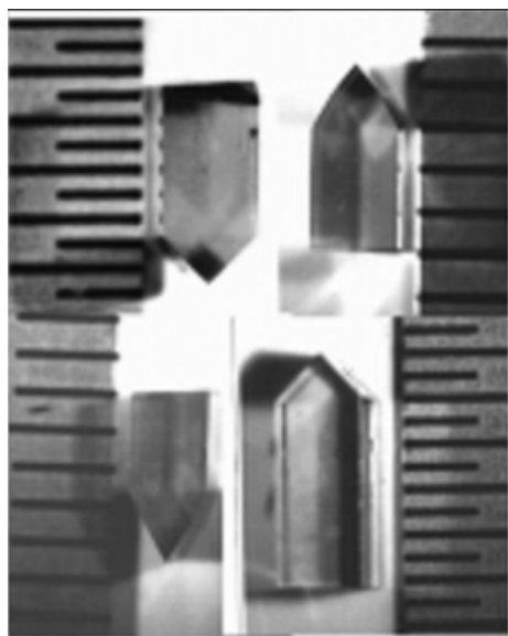
Рис. 11. Оптический снимок призм из кристаллов синтетического алмаза.
