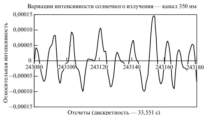
Рис. 1. Пример сигнала в канале 350 нм спектрофотометра ДИФОС/КОРОНАС-Ф, представляющего собой набор гармоник с разными периодами, амплитудами и фазами и наложенным на них шумовым спектром (сигнал очищен от отраженного от земной атмосферы света).
