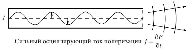
Рис. 5. Схематическая картинка газового лазера. Стоячая световая волна в разрядной трубке генерирует интенсивный ток поперечной поляризации в газе. Его осцилляции поддерживают стоячую волну и излучают световой пучок.
