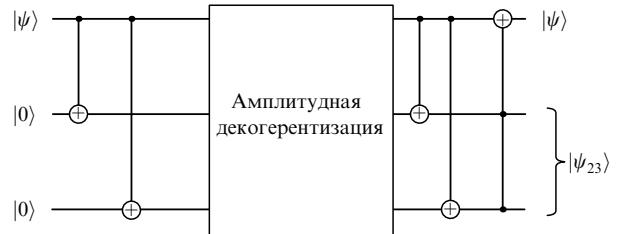
Рис. 12. Схема протокола коррекции квантовой амплитудной ошибки.
