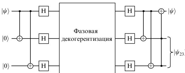
Рис. 13. Схема протокола коррекции квантовой фазовой ошибки.
