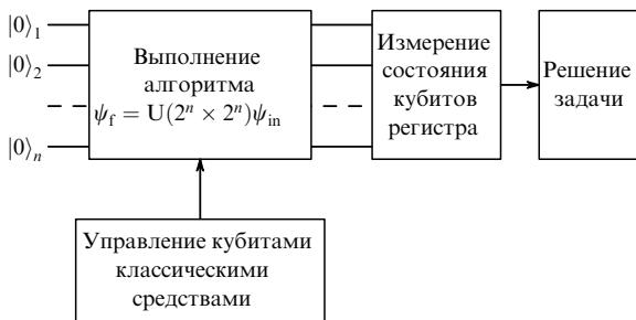
Рис. 5. Схема квантового компьютера.
