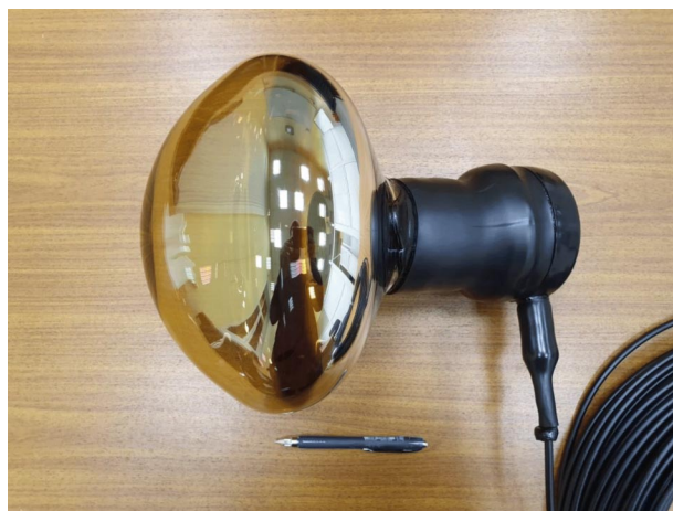
Рис. 5. Фотография 10-дюймового фотоумножителя R7801-100 [30].
