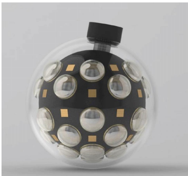
Рис. 11. Оптический модуль проекта TRIDENT [41].
