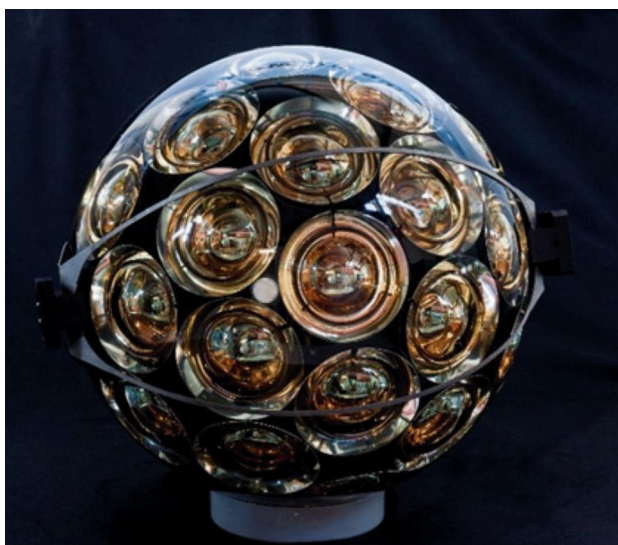
Рис. 9. Оптический модуль нейтринного телескопа KM3NeT [33].
