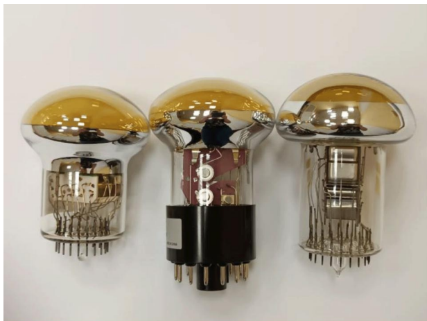
Рис. 10. Фотография трёхдвоймовых фотоумножителей. Слева направо: XP72B20, R14374 и СФЕРА.
