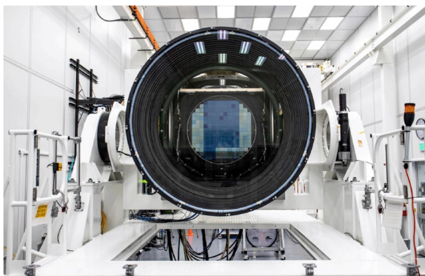
Рис. 7. Мозаичная камера из 3,2 млрд элементов для LSST в сборочном цехе.
