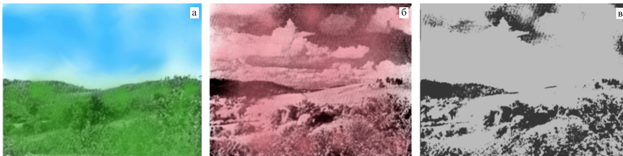
Рис. 1. Демонстрация принципа дополнителности на примере двух изображений одного и того же ландшафта. Снимки (а) и (б) сделаны одновременно: (а) в видимом свете, (б) в ИК-области с длиной волны 3–5 мкм; (в) разностный снимок между снимками (а) и (б). Вода хорошо поглощает волны в ИК-диапазоне, поэтому отчётливо выделяются облака и другие насыщенные водой элементы ландшафта.
