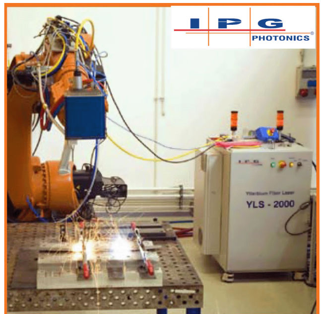
Рис. 8. Лазерный технологический комплекс на основе мощного волоконно-оптического лазера компании IPG Photonics ( www.ipgphotonics.com ).
