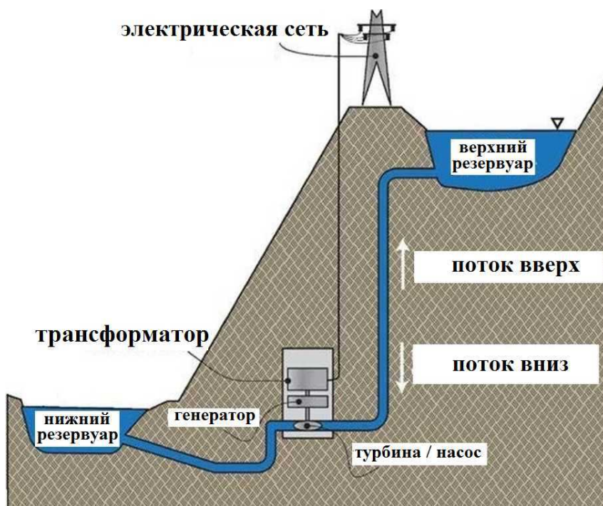
Figure 19: Схема работы насосной гидроэлектростанции [165].
