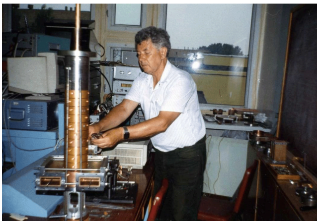
Н.П. Собенин настраивает симметризованный ввод мощности. (Фотография была сделана в 1990-е годы.)
